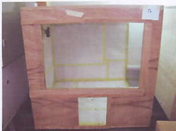
Fig 1 Exemple de cage expérimentale (en verre et bois) pour l'Aérosol SWORD.
